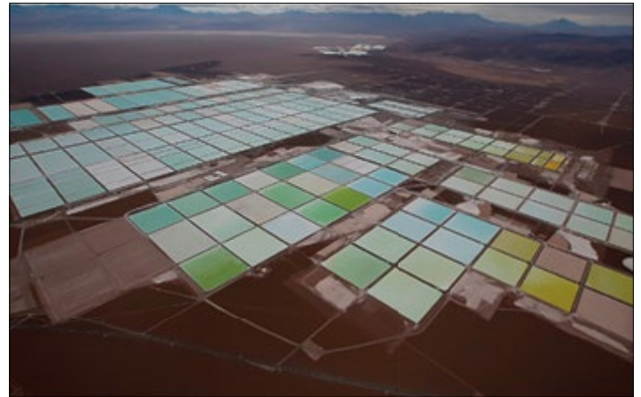
Bild: Solare Lithium-Trocknung in der Atacama-Wüste. Quelle: https://www.roedl.de/themen/erneuerbare-energien/2019-11/lithium-batterie-elektroautos-energie-wende-mobilitaetswende
